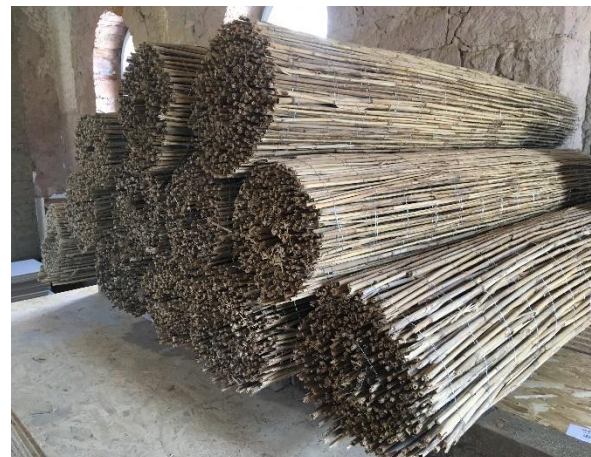
Abbildung 1: Schilfrohmatten als Baustoff in der Restaurierung Foto: J. Saltzmann/JKI
