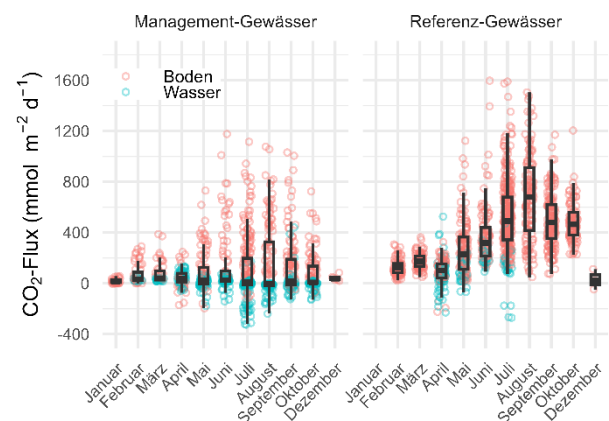
Abbildung 2: \text{CO}_2 -Flux ( \text{mmol CO}_2 \text{ m}^{-2} \text{ Tag}^{-1} ) aus dem wiedervernässten Management- (links) und dem Referenz-Gewässer (rechts). Vergleich der Emissionen aus Gewässeroberfläche (Wasser, blau) und trockenen Bereichen (Boden, rot) im Jahresverlauf (2023-2025).
