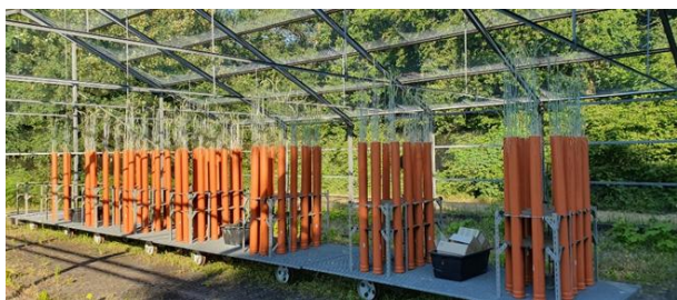
Abbildung 4: Gefäßversuch zur Wurzelphänotypisierung unter Freilandbedingungen und Niederschlagsausschluss.
