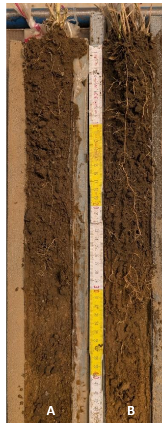
Abbildung 3: Mit einem benzinbetriebenen Schlagbohrsystem entnommene Bodenkerne von A. einjährigem Weizen und von B. Kernza® im Jahr Zwei nach Aussaat. Quelle: eigene Aufnahmen
