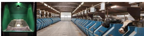
Abbildung 1: GreenFeed Methanmesstation und Wiegetröge zur Messung der tierindividuellen Futteraufnahme. Quelle: Dirk von Soosten
