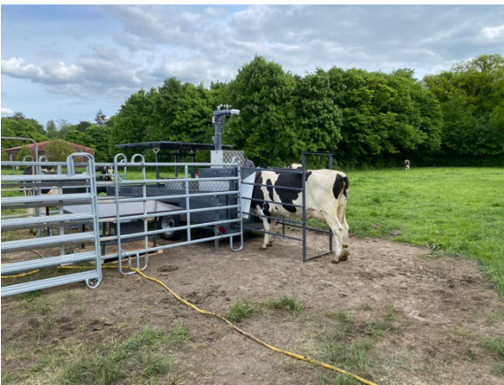
Kombinierte Anlage zur Fütterung von Rindern und zur Messung des Methanausstoßes.
